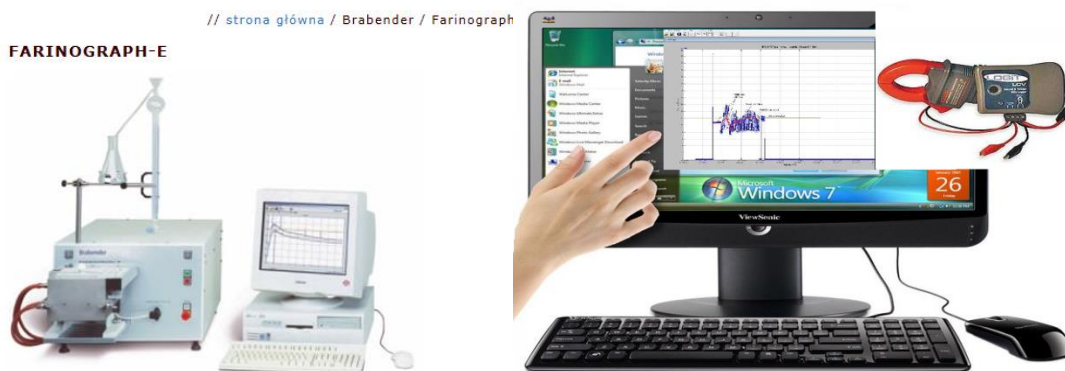
Figura 1: a. Farinograful Brabender; b. Aparat portabil de înregistrare a curentului consumat la frământarea aluatului
